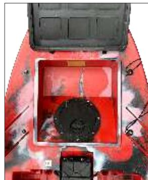
Detalhe do compartimento de proa com tampa de inspeção para acesso ao casco
